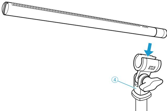
Um die Übertragungen von Körperschallgeräuschen mechanisch zu unterdrücken, verwenden Sie die optional erhältliche Schwinghalterung.
