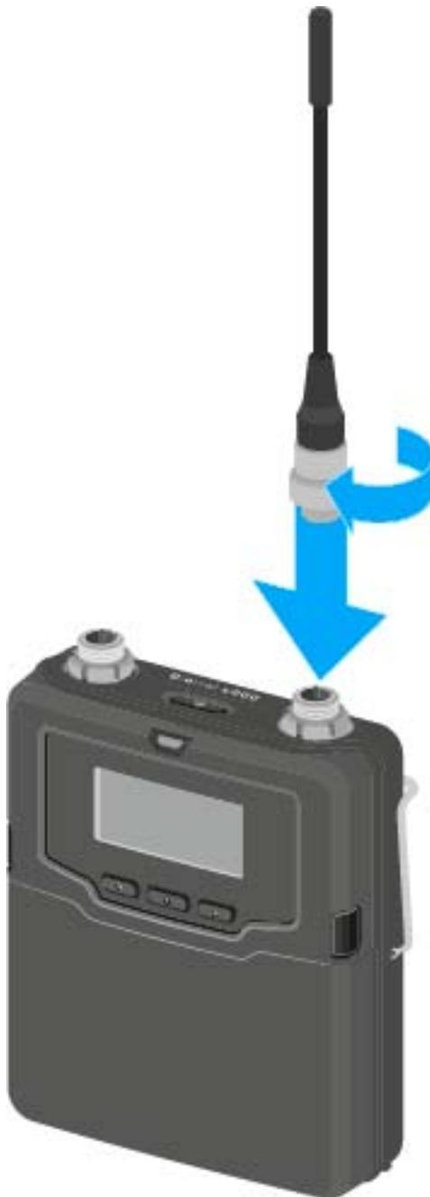
**i** Die Antenne lässt sich ganz leicht in nur einer Ausrichtung in die Antennenbuchse stecken. Stecken Sie die Antenne nicht mit Gewalt in die Antennenbuchse des Taschensenders.
