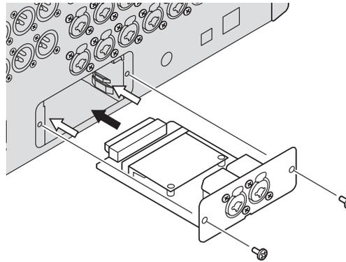
Achten Sie darauf, dass die Seiten der NY-Karte an den Führungsschienen des Geräts ausgerichtet sind, in dem Sie sie installieren.
