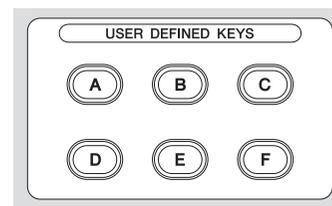
Im Grundzustand des Pults sind die USER DEFINED KEYS (Seite 14) als „Direct Scene Recall“-Tasten konfiguriert. Sie können eine Scene speichern, indem Sie eine der USER DEFINED KEYS gedrückt halten, und eine Scene abrufen, indem Sie eine der USER DEFINED KEYS drücken.
